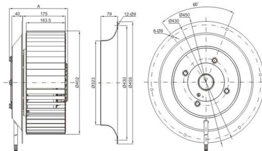
Трехфазные вентиляторы работают как с напряжением 3 ~ 380V (Y), так и 3 ~ 380V (Δ). Концы всех обмоток выведены отдельно.
